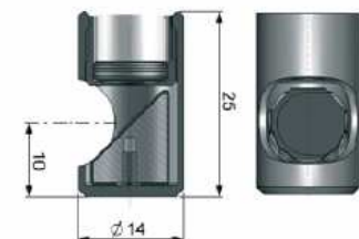
Ermöglicht Messungen im 90°-Winkel
