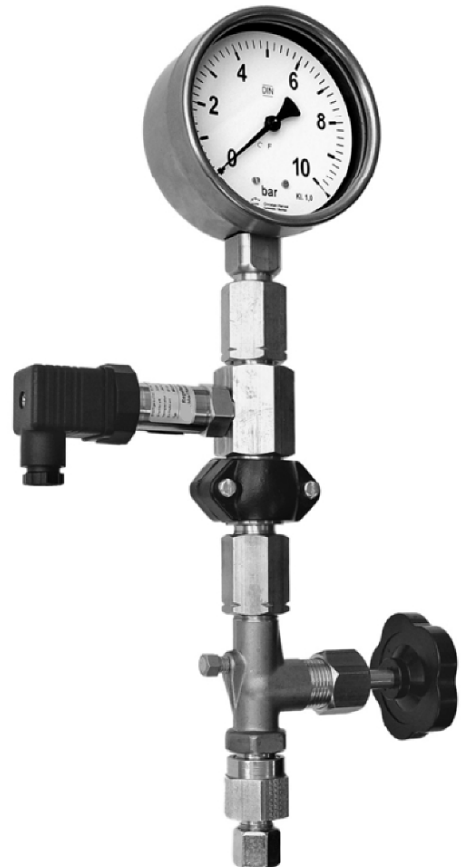
Druckmessstation mit Rohrfedermanometer NG100 – und Drucksensor für Wandaufbau mit Manometerventil
