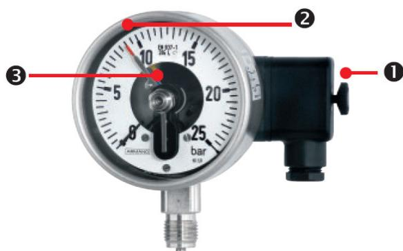
Durch Eindrücken des Verstellschlüssels (1) in das Verstellschloss (3) und gleichzeitiges Drehen des selbigen sind die Sollwertzeiger (2) über den gesamten Skalenbereich frei einstellbar.
