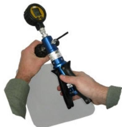
20 bar können so sicher und gut dosiert aufgebaut werden. Über 20 bar wird die Druck-erzeugung zunehmend schwieriger.
