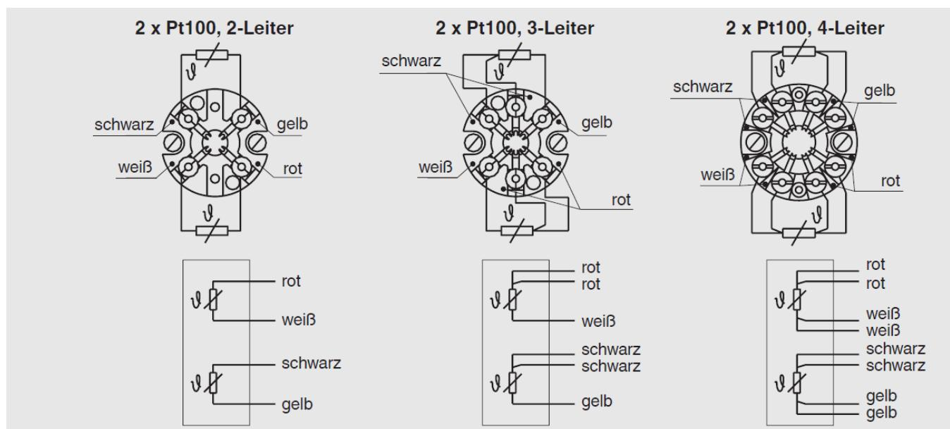
Die elektrischen Anschlüsse eingebauter Temperatur-Transmitter können den entsprechenden Datenblättern bzw. Betriebsanleitungen entnommen werden.
